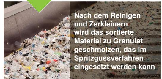
Nach dem Reinigen und Zerkleinern wird das sortierte Material zu Granulat geschmolzen, das im Spritzgussverfahren eingesetzt werden kann
